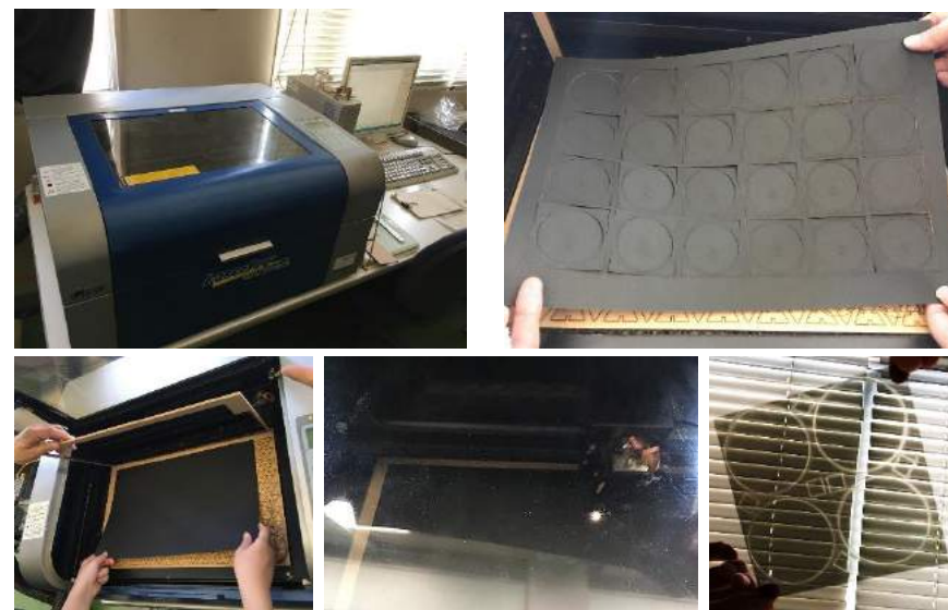
画用紙と偏光フィルムの加工の様子 レーザーカッターを使用しました。 100枚でもアツという間！
