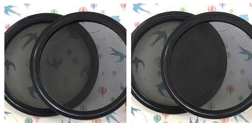
左：偏光板を同じ向きに2枚重ねた 右：左図から上だけ90度回した
